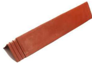
Angular: Lateral y Cierre bajo cumbrera / limatesa Dimensiones: 57 x 11 x 10 cm Peso: 750 gr
